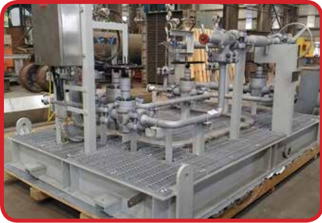
ANNULI RISER SKID
