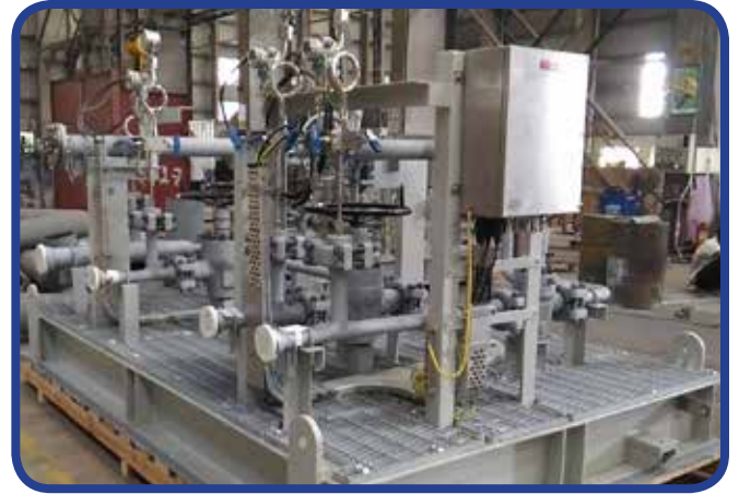
ANNULI RISER SKID
